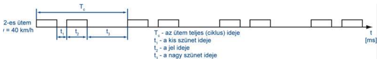
8. ábra A sínáramkör modulált jelének, táviratának felépítése
